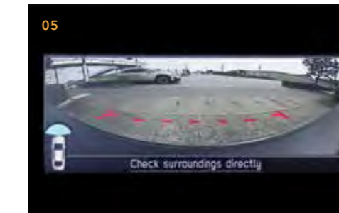
05. КАМЕРА ПЕРЕДНЕГО ОБЗОРА
